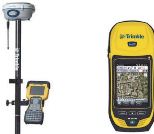
Slika 3: TRIMBLE R8 i GNSS uređaj TRIMBLE GEO 7X
