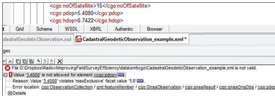
Slika 7: Prikaz nedozvoljene vrijednosti atributa PDOP u XML uređivaču
