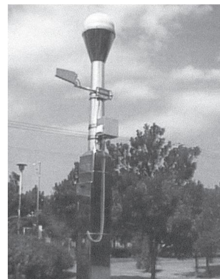
Slika 2: GNSS – permanentna stanica smještena na stupu visokom 5 m. Na njemu je smještena GNSS antena, GNSS prijamnik, uređaji za napajanje električnom energijom, uređaji za prijenos primljenih radio signala s raznih pozicijskih satelita do kontrolnog računskog centra, zaštita od gromova, ali i zaštita od krađe. Stup je inače postavljen na duboko ukopan temelj. Tako je cijena uspostave GNSS – permanentne stanice vrlo velika.
