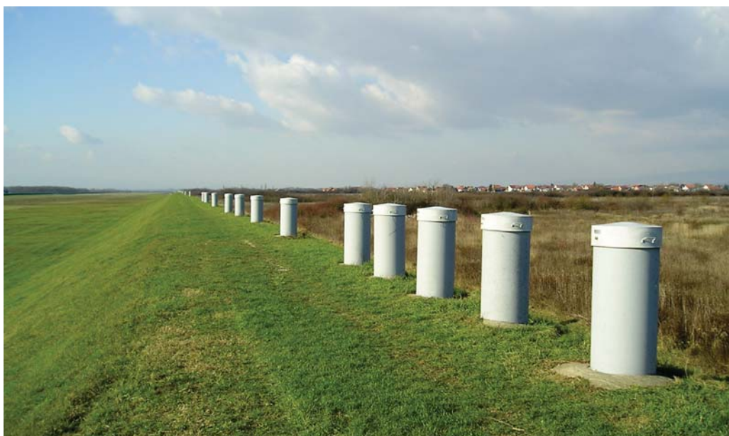
Slika 1. Kalibracijska baza Geodetskog fakulteta Sveučilišta u Zagrebu (Zrinjski 2010).
