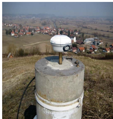
Slika 3.1b) Centar temeljne točke
