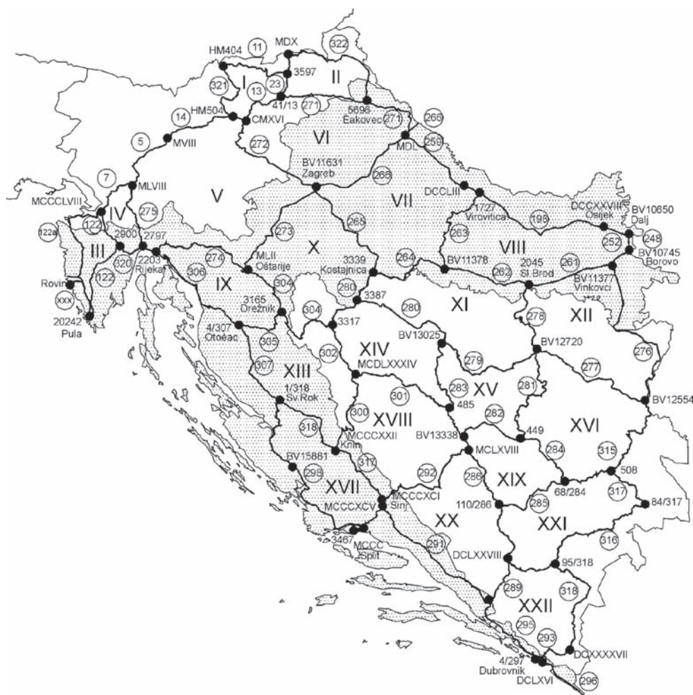
Slika 1. Nivelmanska mreža I. nivelmana visoke točnosti (INVT)
